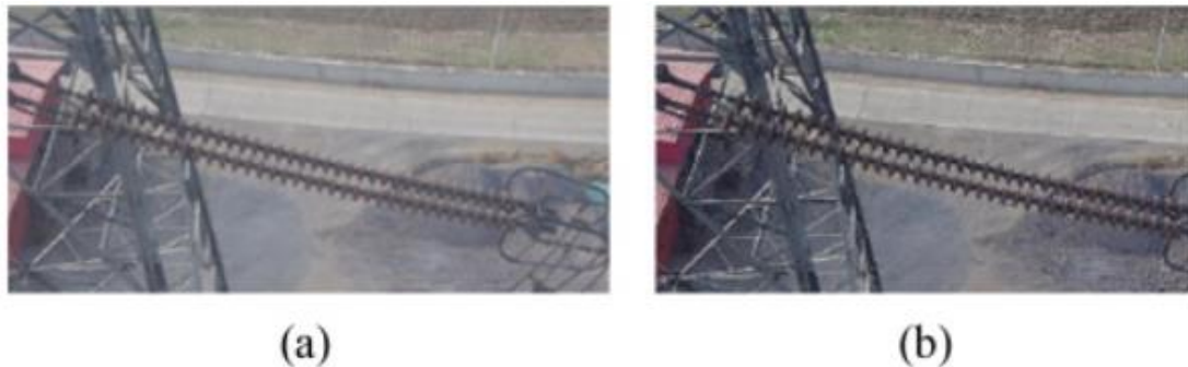
شکل 2: نمودار شماتیک اثر شارپنس لاپلاسی (الف) تصویر قبل از شارپنینگ. (ب) تصویر تیز شده
