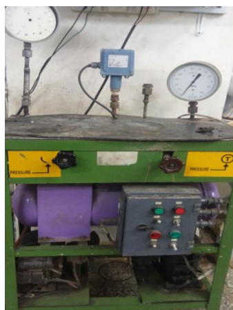
شکل ۱۰- کالیبراسیون گیج های فشار لوله ورودی
